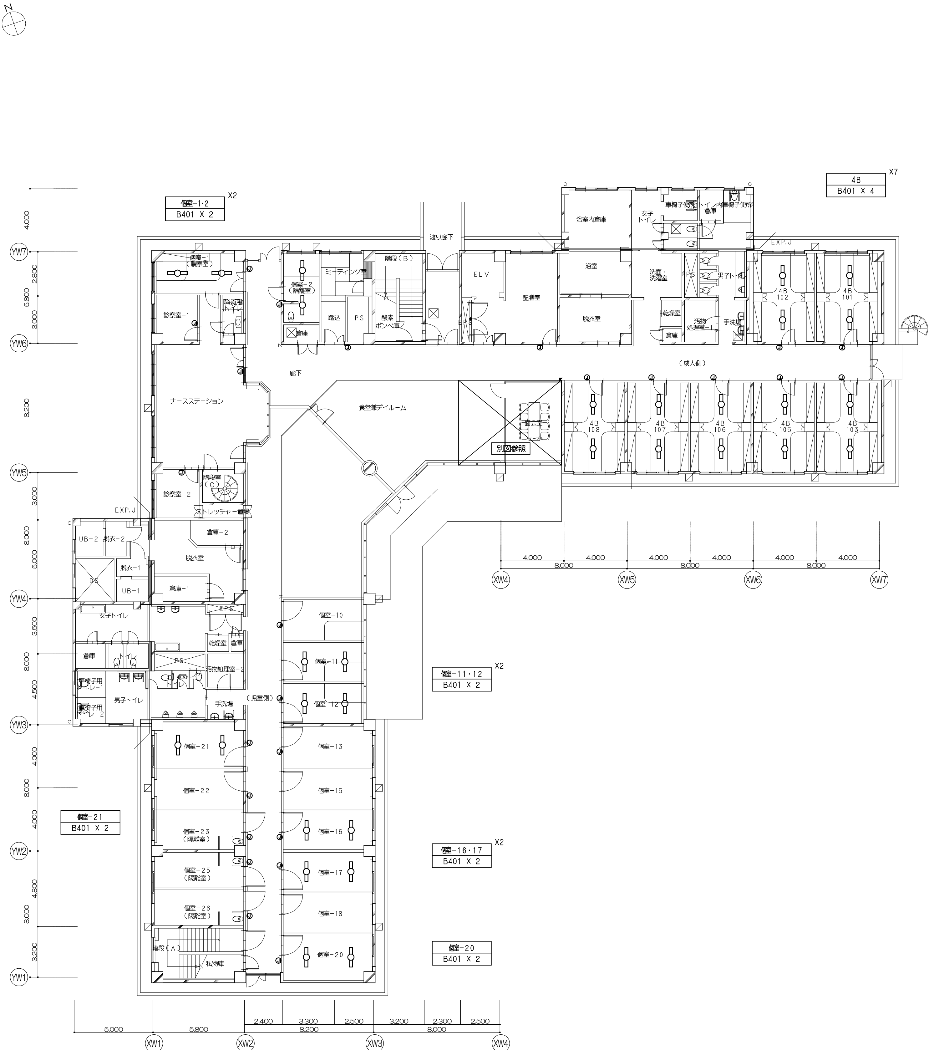
電灯設備 1階平面図(改修)
