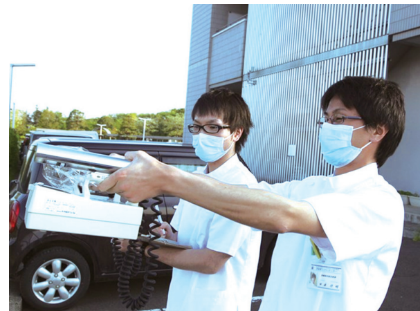
診療放射線技師2人によるサーベイメータで実際に測定と記録しているところ
